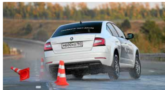
При выполнении «переставки» водитель раз за разом увеличивает скорость на 1–2 км/ч, пока не начнет «косить» конуса. Максимальные показатели удачно выполненного маневра заносят в протокол.
