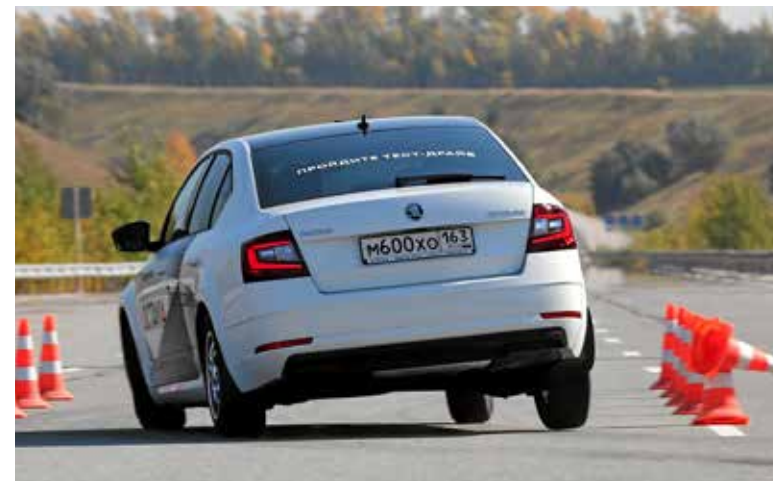
12-метровая «переставка» позволяет оценить поперечные сцепные свойства и уводы шин на скорости близкой к городской.
